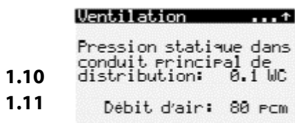
Figure 41 – Pression statique selon le débit d'air actuel.
